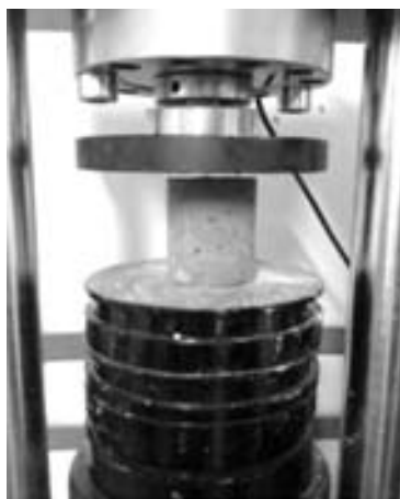
Fig. 5. Provino iniettato con microcemento, in fase di esecuzione della prova di compressione monoassiale. Soil sample injected by microcement, during the uniaxial compressive strength test execution.
